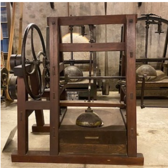
写真 3：台湾に現存する日本統治時代の望月式揉捻機 (筆者撮影)
